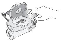
Empuje la sección marcada "PUSH CLOSE" en la tapa del compartimiento del disco para cerrarla. 1 Abra la tapa de la ranura de la tarjeta.
